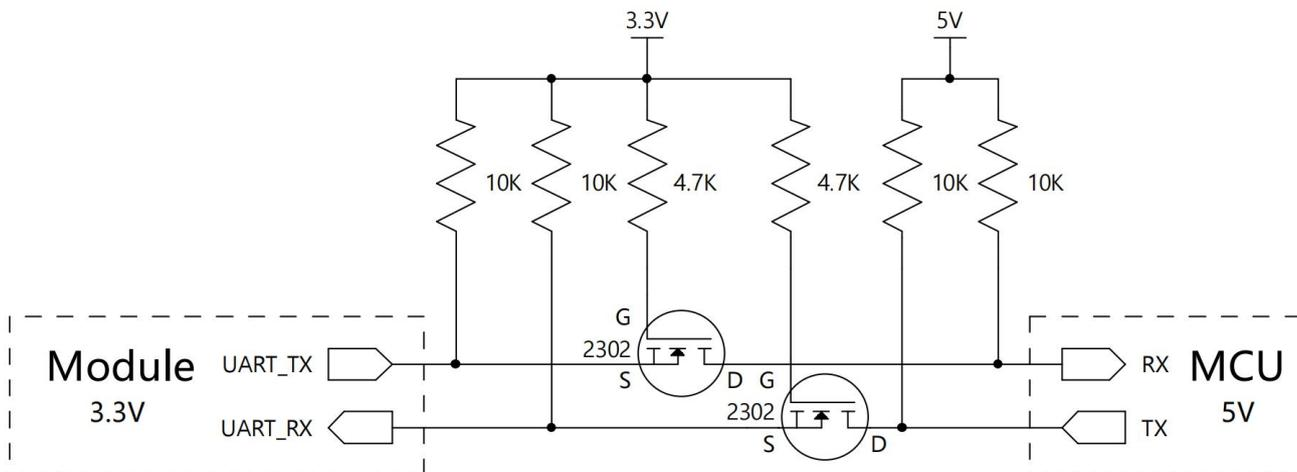
图 12: 串口电平转换参考电路
