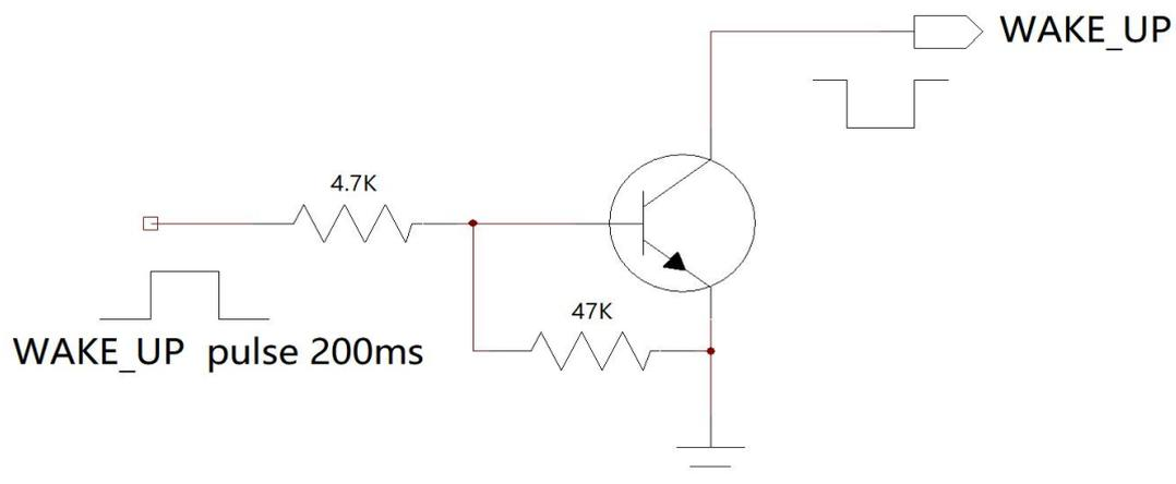
图 7: 开集驱动唤醒参考电路
