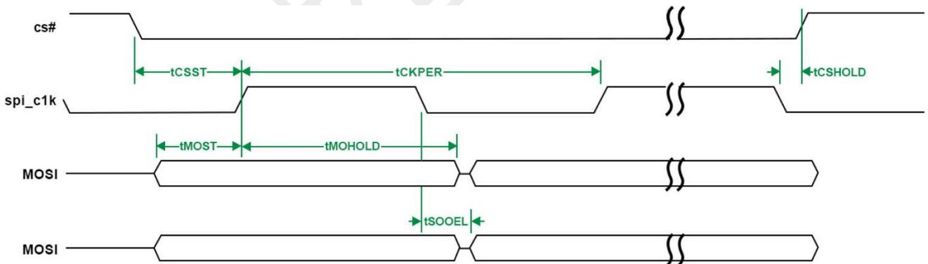
图 10: SPI 通信时序图
