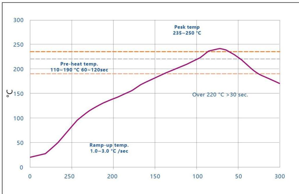
图 18: 推荐的回流焊温度曲线
