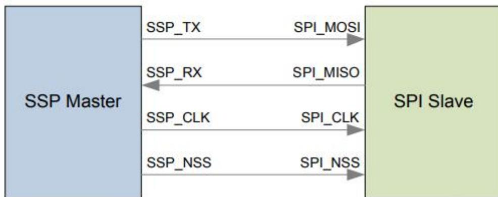
图 13：SSP master 与 SPI slave 之间的连接
