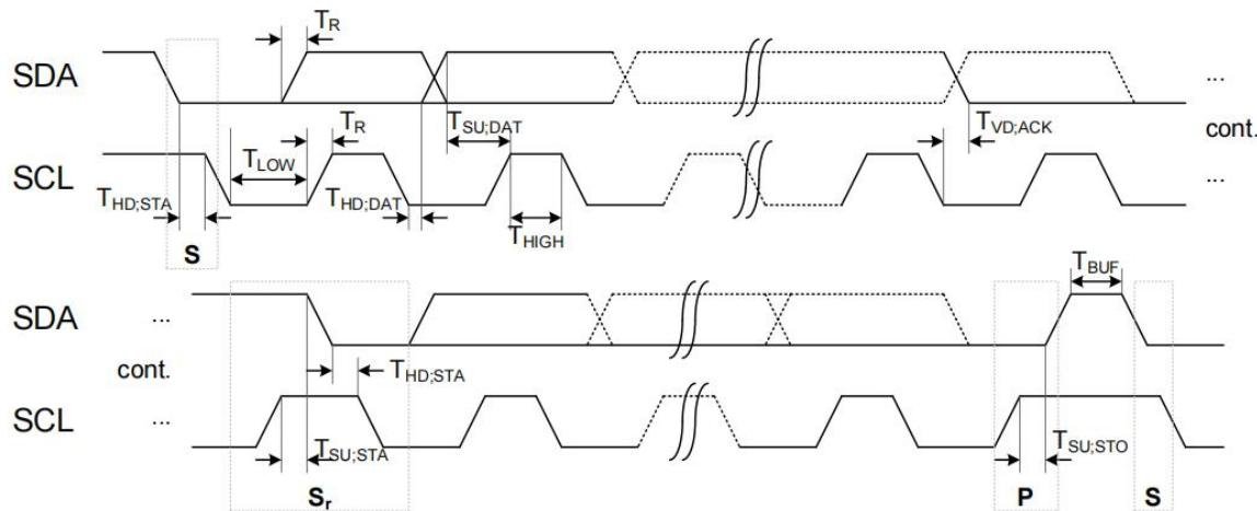
图 10: IIC 通信时序图
