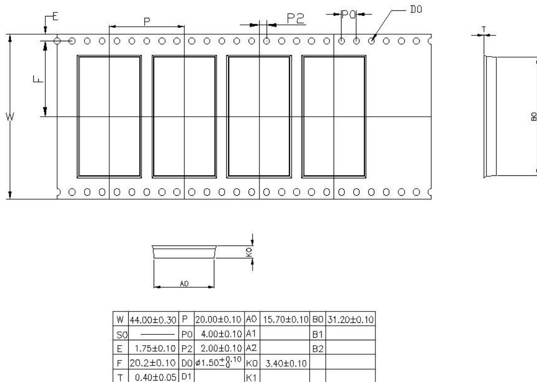
图 25：载带尺寸 (单位：毫米)
