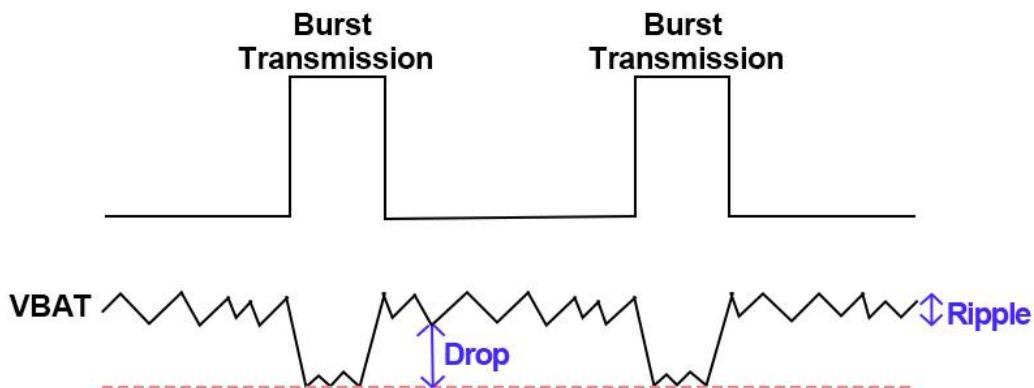
图 6：突发传输电源要求
