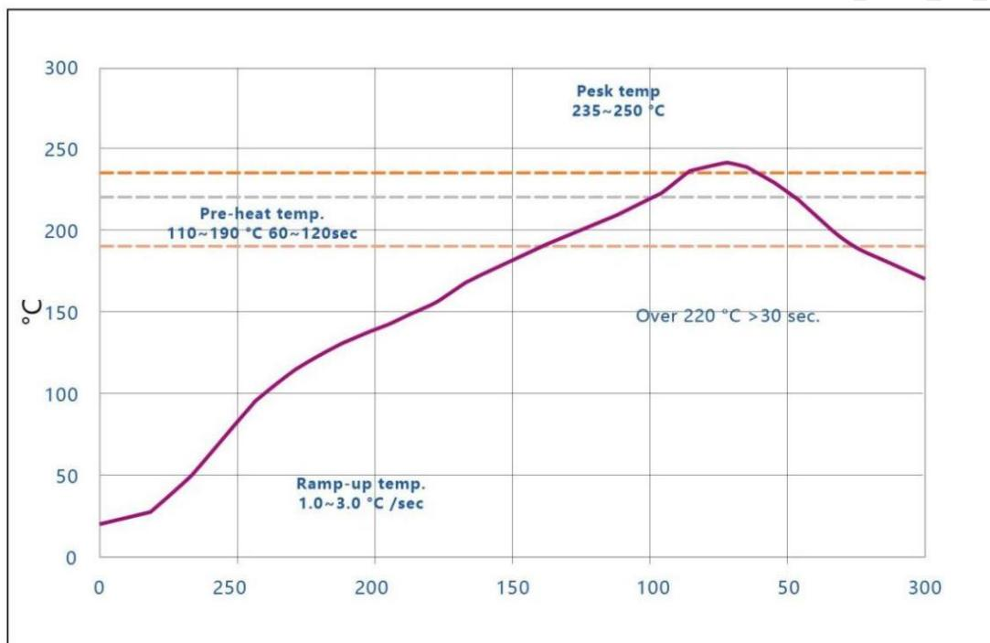
图 24：推荐的回流焊温度曲线
