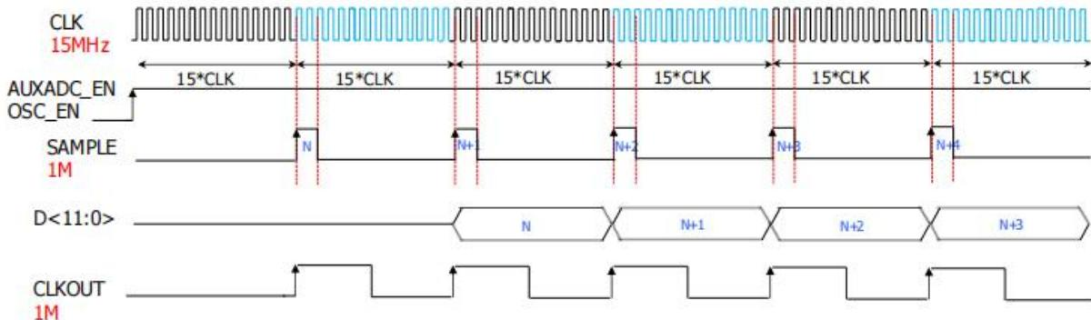
图 18: 12 位 ADC 时序图
