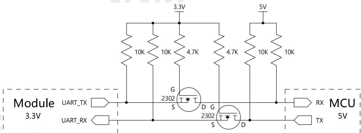
图 20: 串口电平转换参考电路
